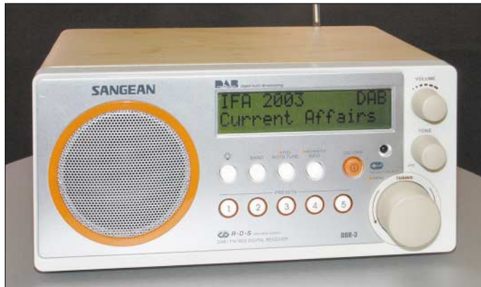
Sangean DDR 3: Ein kleines Wohnzimmerradio im Stile des Evoke; mit Fernbedienung, optischem Digital- ausgang für den HiFi-Receiver, zusätzlich UKW/RDS und Holzgehäuse
