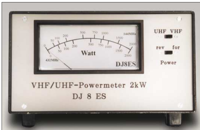
Bild 1: Der fertig aufgebaute und abgeglichene Leistungsmesser für VHF/UHF
