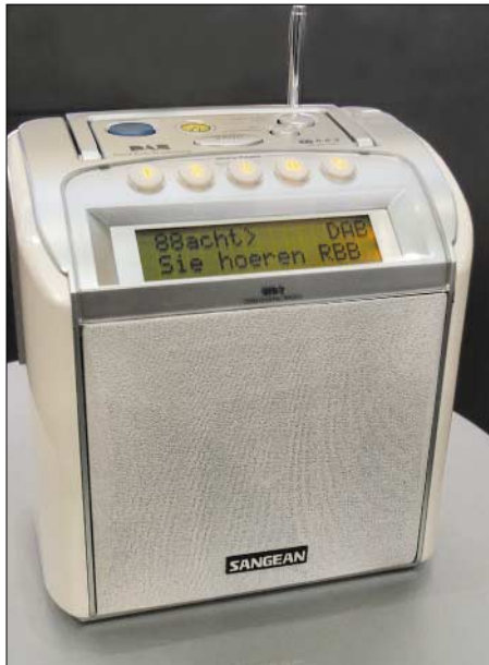
Sangean DPR 2: Ein UKW- und DAB-Kofferradio, das mit vier Monozellen oder am Netzbetrieben werden kann
